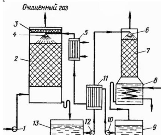
Состав схемы: 1 — вентилятор (газодувка); 2 — абсорбер; 3 — брызгоотбойник; 4, 6 — оросители; 5 — холодильник; 7 — десорбер; 8 — куб десорбера; 9, 13 — емкости для абсорбента; 10, 12 — насосы; 11 — теплообменник-рекуператор
